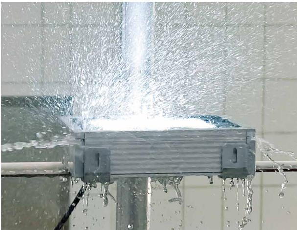
> Strahlwasserprüfung im NORKA-Labor
